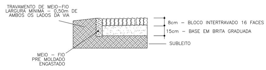
**DETALHE DA SEÇÃO - PAVIMENTAÇÃO NOVA**
