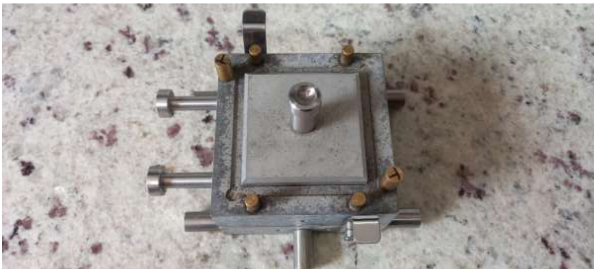
Figure 25 – Caixa de cisalhamento finalizada - Fonte: V7/2022
