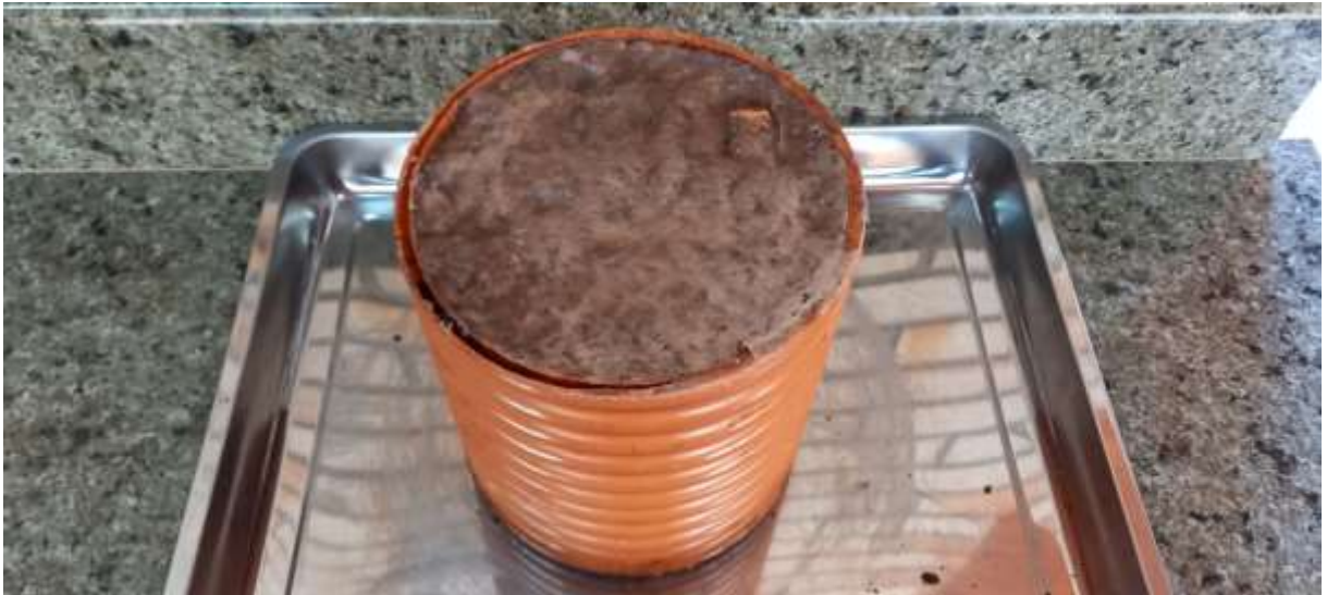
Figure 12 – Conformação e confinamento da AM 01 - Fonte: v7/2022
