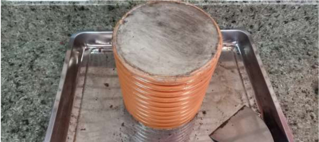
Figure 14 – Conformação e confinamento da AM 03 - Fonte: v7/2022
