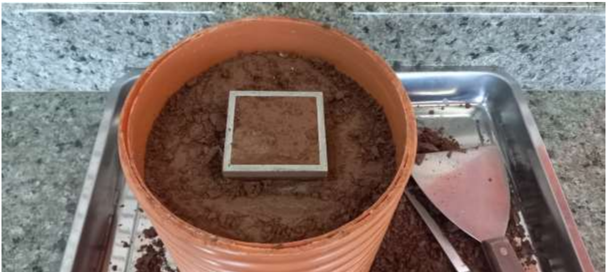
Figure 19 – Talha do corpo de prova 01 da AM 02 - Fonte: v7/2022
