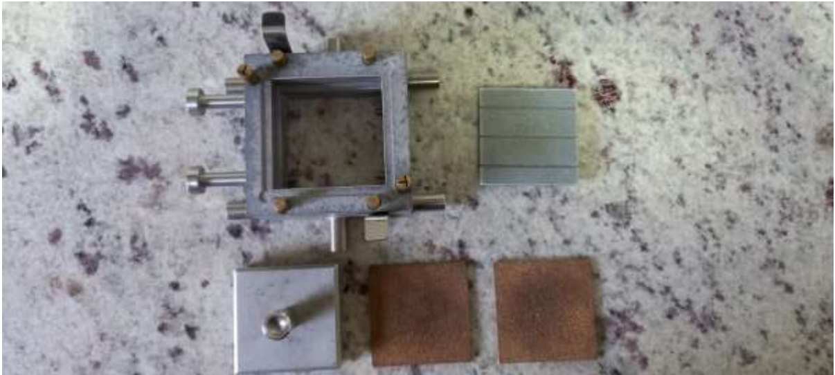
Figure 24 – Componentes que compõem a caixa de cisalhamento - Fonte: V7/2022
