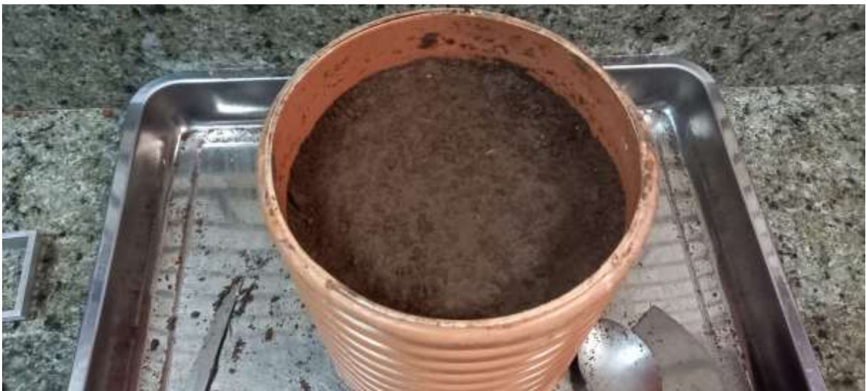
Figure 17 – Raspagem superficial da AM 03 - Fonte: v7/2022
