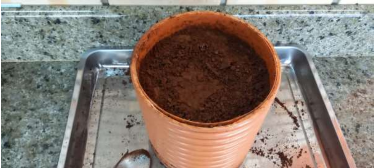
Figure 16 – Raspagem superficial da AM 02 - Fonte: v7/2022
