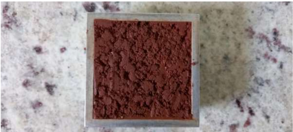
Figure 21 – Resultado final do anel + solo da AM 01 - Fonte: V7/2022
